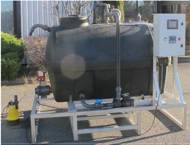
Grâce à cette méthode brevetée, **l'intégralité du CO<sub>2</sub> utilisé est transformée en acide carbonique. Un système de recirculation ingénieux capte le gaz non dissous et le réintroduit dans l'effluent.**
