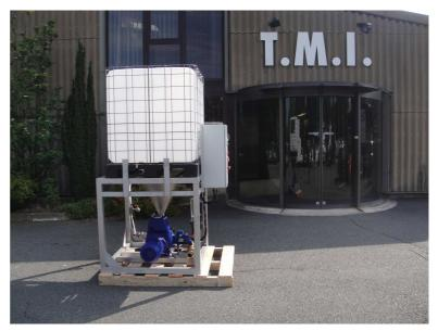
Le châssis de ce poste de préparation, entièrement réalisé en inox 304L, est conçu pour supporter un container 1000l type IBC.
