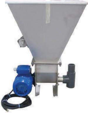
Le dosage continu des produits secs ou légèrement humides a toujours été une préoccupation sérieuse dans l'industrie et seuls des spécialistes peuvent répondre à ce besoin. Nos systèmes de dosage de poudre comprennent une trémie qui peut être alimentée manuellement ou par un autolift (en options), une vis de dosage sous la trémie garantit un débit précis grâce à un variateur.
